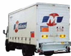
Capac. 1500-2000 kg (6 cilindros - placa acero)
